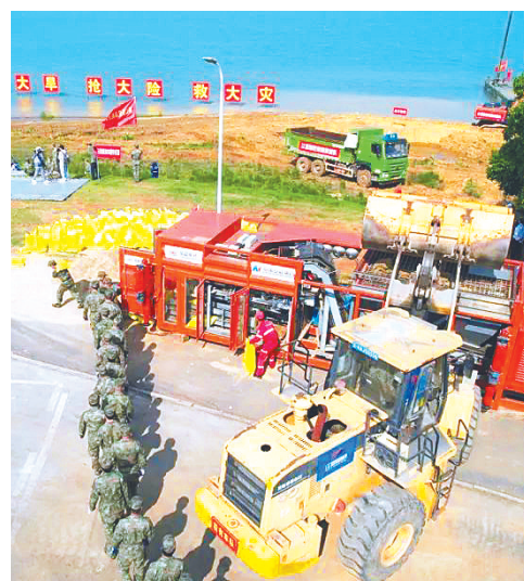
砂石装载机自动填装沙袋。(湖北日报通讯员 梅芷伊 摄)
