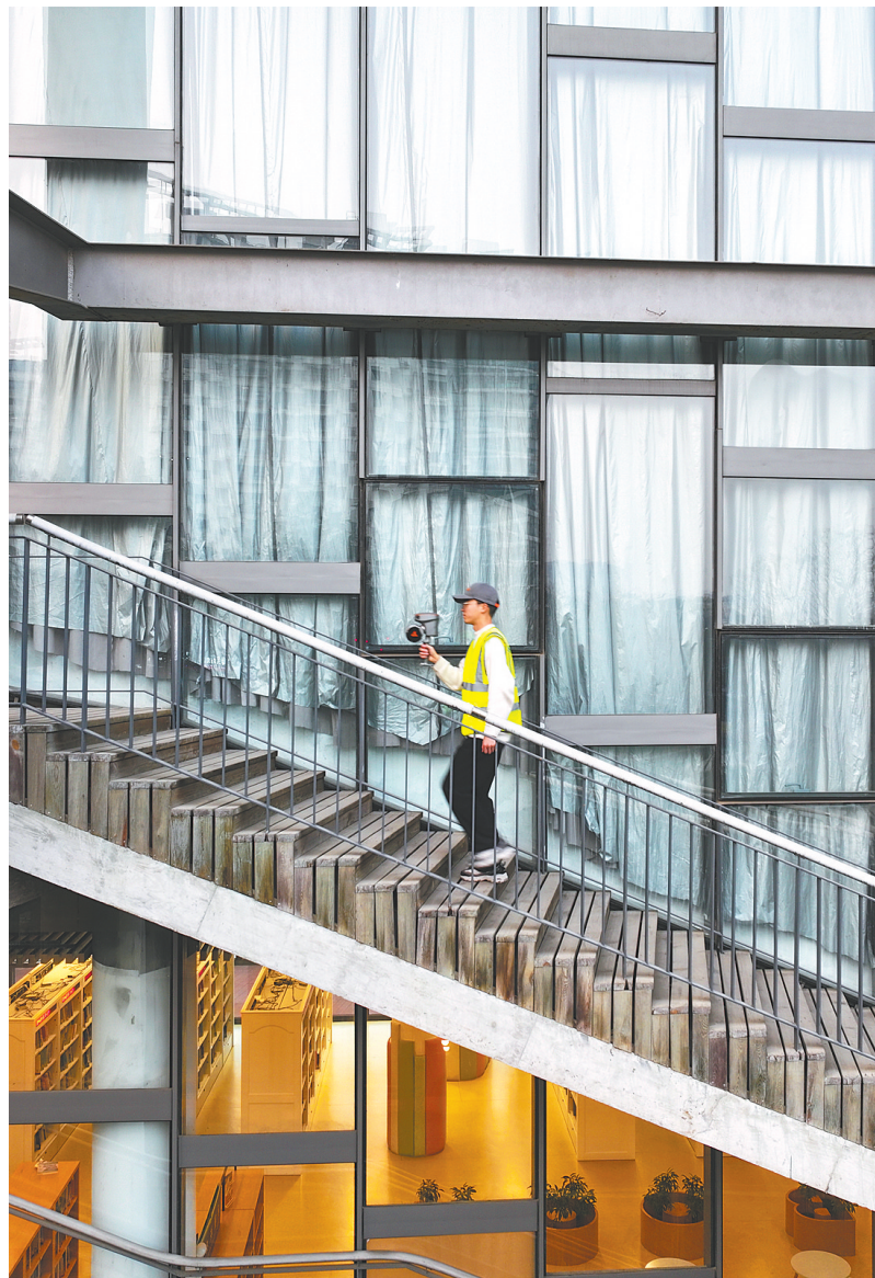
在北斗技术的加持下,华测首款手持扫描仪,每秒可以获取10万点的测距和测角数据信息。(图片为受访者提供)
