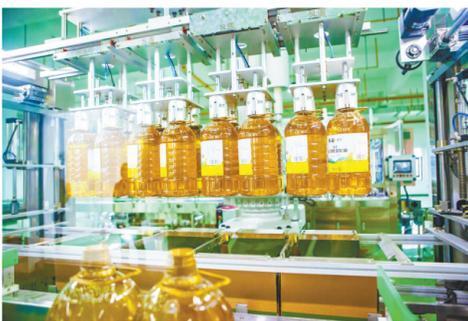
湖北荆品油脂有限公司的“农谷壹号”高油酸菜籽油灌装生产线。(林锐 提供)
