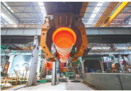
黄石新港园区,黄石新兴管业热模生产线上,浇铸成型的球墨铸铁管正在被吊运行进退火处理。
