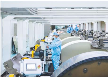
在黄石诺德锂电铜箔产业园,工作人员检验生产出的铜箔。
