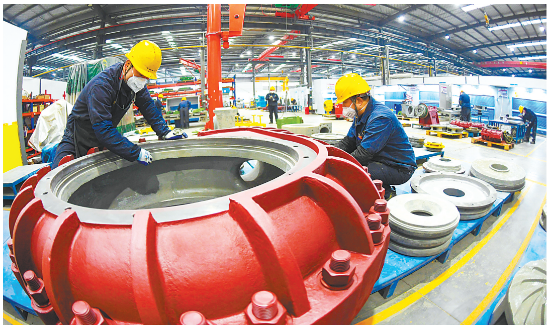
连日来,汉江弘源襄阳公司员工加紧生产陶瓷泵赶订单。作为全国首家碳化硅陶瓷泵企业,该公司研发出50余种节能、环保、高效的产品,今年一季度订单已达1800余万元,产品出口德国等国家。(湖北日报全媒体记者 田悦 通讯员 张沛 谢勇 摄)
