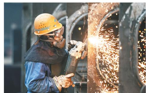
2月19日,在武汉市新洲区的中国一冶科工钢结构分公司生产车间内,火花飞溅。工人们打磨、电焊、切割钢板,为武汉范湖立交改造工程、宜昌夷陵长江大桥等省内重大工程加紧制造钢箱梁。
