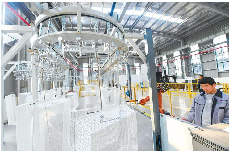
2月18日，湖北赞丰机器人技术公司（襄阳）AI+机器人柔性喷涂系统在工作中。（湖北日报全媒体记者 田悦 摄）
