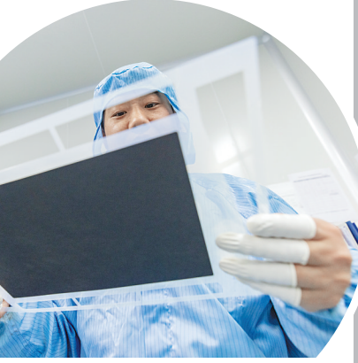
▲2月21日,武汉理工氢电科技有限公司无尘车间,工作人员在进行膜电极产品外观检验。
