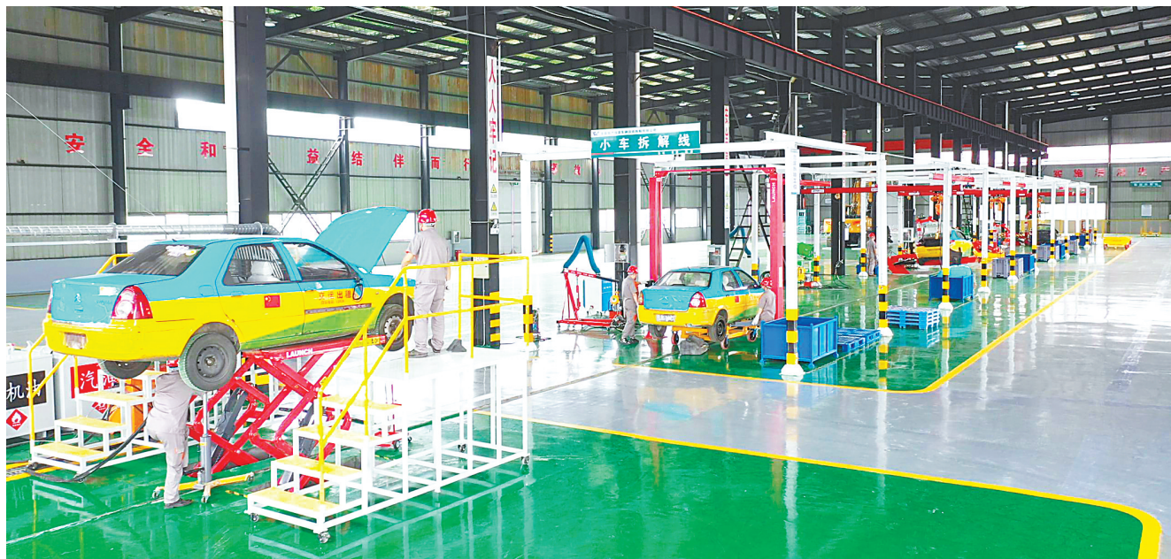
宜昌城发集团物产车拆公司小车拆解线。(通讯员 张伟 摄)
