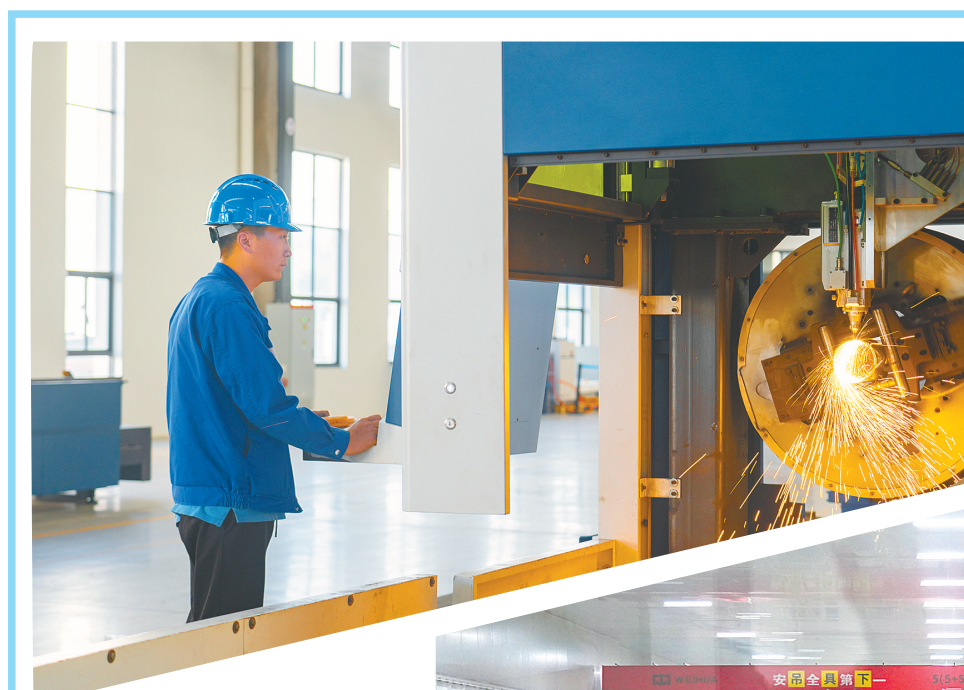
在湖北领创智能激光科技有限公司车间,工人正在操作激光切割机。(通讯员 万阳 摄)
