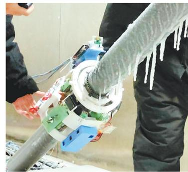
学生们在低温实验室进行机器人缆索除冰实验。(通讯员 刘思逸 摄)
