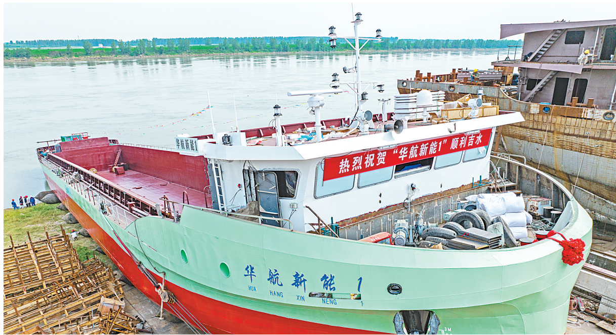
“华航新能1”湖北首艘120标箱新能源纯电动集装箱示范船完成建造并顺利下水。这是我省汉江流域建造的首艘纯电动集散两用船。（湖北日报全媒体记者 刘曙松 摄）
