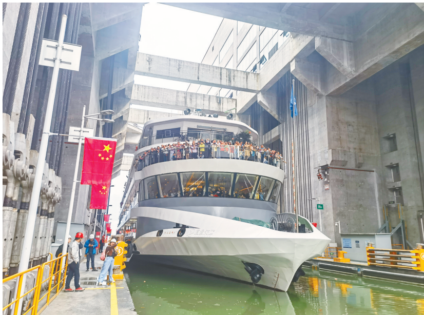
长江三峡5号游轮“坐”升船机过坝。(湖北日报全媒记者 戴辉 摄)
